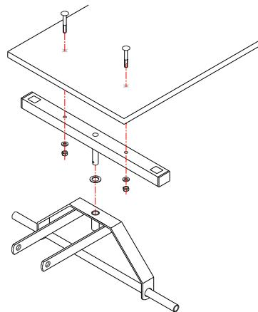
Bevestig de steunbalk met pin aan de bodemplank met twee slotbouten. Leg vervolgens de witte kunststof ring over de stuurpin en steek het voorframe over de stuurpin.
