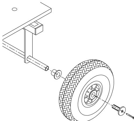
Schuif eerst de opsluitringen en daarna de wielen op hun as. Verwijder eventueel vet dat in de as is gekomen, zodat de wieldop goed vast komt te zitten. Druk de wieldop nu in de as, zodat deze het wiel opsluit en bevestig deze door een schroef in de wieldop te draaien.
