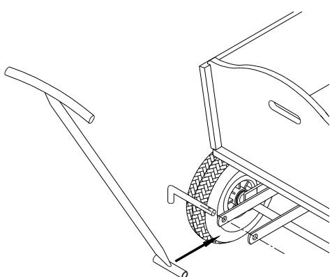
Bevestig nu de trekboom. Houd deze tussen de voorvork en steek bevestigingspen er doorheen.
